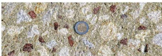
Artevia Roche est un béton abrasé mécaniquement destiné à des aménagements extérieurs décoratifs.
