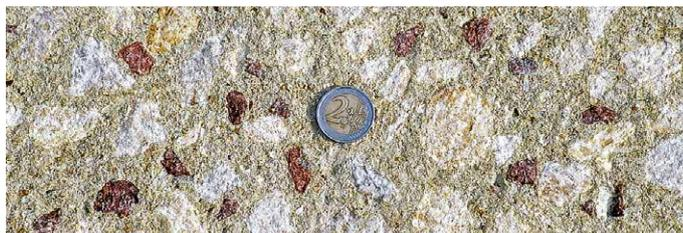
Artevia Roche est un béton abrasé mécaniquement destiné à des aménagements extérieurs décoratifs.
