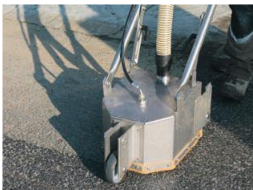
Photo 99 - Le nettoyeur injecte de l'eau sous pression.
