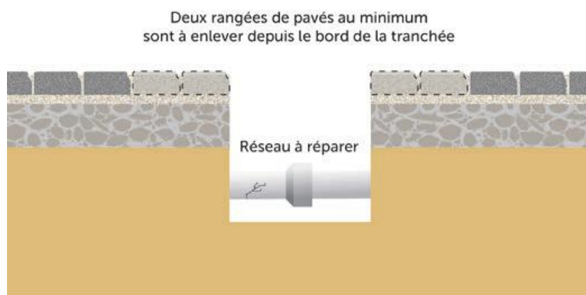
Figure 31 - Dépose du revêtement en produits modulaires pour accéder à la zone d'intervention sur réseau.
